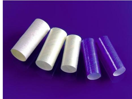
Das nicht schrumpfende Mylar®/Nomex®-Isolierrohr dient der robusten Isolierung in elektrischen Anwendungen. Es wird sehr genau aus einem Verbund von Mylar® und Nomex® gewickelt. Es weist eine hohe elektrische Durchschlagsfestigkeit und mechanische Schlagfestigkeit auf und ist auch für anspruchsvolle Anwendungen geeignet. Es verhindert elektrische Kurzschlüsse in Wicklungen von Elektromotoren.
