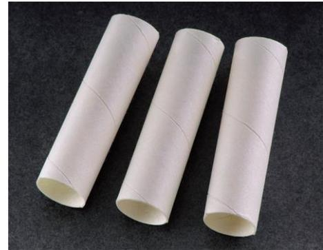
Das nicht schrumpfende Isolierrohr aus kalandriertem Nomex® 410 ist sehr geeignet zur Isolierung von elektrischen Leitungen in Elektromotoren und Anwendungen der Luftfahrt und der Automobilindustrie. Die Zugfestigkeit und der Durchgangswiderstand bleiben auch bei hohen Temperaturen erhalten.
