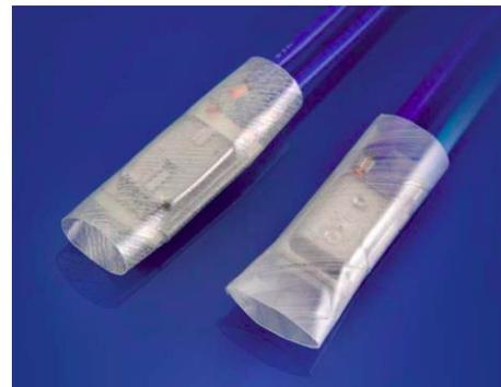
Das Isolierrohr aus Hostaphan® ist das bevorzugte Material zur Isolierung von Temperaturwächtern und Sensoren. Auch nach dem Schrumpfen bleibt das Aussehen erhalten und das Material flexibel. Es kann bis zu Temperaturen von 160 °C eingesetzt werden.
