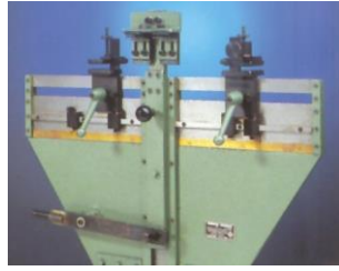
Wickel- und Ausziehvorrichtung
