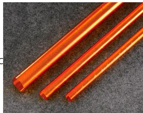
Les tubes isolants non-rétractables, enroulés de plusieurs couches en Kapton® sont revêtus d'une couche en Teflon® et sont insensibles envers l'humidité. Ils sont appliqués dans l'industrie spatiale, aéronautique et automobile dans des conditions les plus dures où une haute rigidité diélectrique et stabilité mécanique sont exigés malgré des épaisseurs de paroi minces. La construction avec une soudure sans colle garantit que le produit ne contient que du polyamide et du Teflon®.
