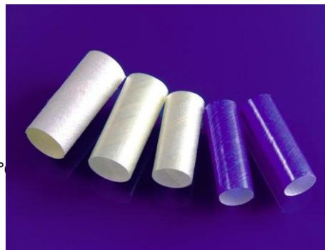
Les tubes Mylar® isolants, enroulés, non-rétractables servent à l'isolation robuste dans d'applications électriques. Ils sont enroulés précisément de plusieurs couches de DuPont™ Mylar® et Nomex® 410. A cause de leur haute rigidité diélectrique et résilience, ils sont très appropriés à des applications exigeantes. Ils sont utilisés surtout comme isolation secondaire dans des bobines de moteurs électriques, imprégnés ou ouverts et évitent des courts-circuits dans des bobines d' un moteur.
