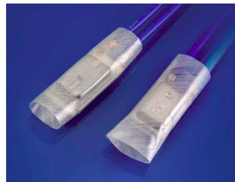
Le tube isolant en Hostaphan® est le matériau préféré pour l'isolation de contrôleurs de température et de capteurs. Même après la rétraction l'apparence et la flexibilité du matériau se conservent. Le tube isolant peut être appliqué jusqu'à la température de 160 °C.
