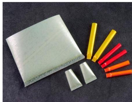
Les capuchons de fermeture Mylar®/Nomex®, thermo-rétractables, isolent et sécurisent des connexions électriques dans des moteurs électriques et d'autres applications et possèdent une haute résilience et rigidité diélectrique. Ils sont appropriés à des applications exigeantes en classe de température F. En court terme, ils supportent des températures jusqu'à 160 °C et sont appliqués surtout dans des moteurs électriques, imprégnés de vernis.
