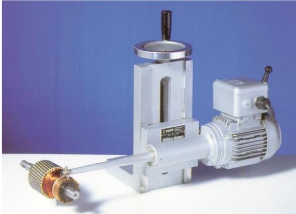
Scies électriques pour fraiser l'isolant des collecteurs
