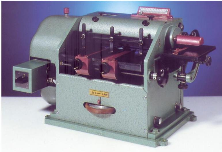
Machine pour plier et pour border les isolants d'encoche
