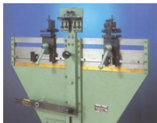
Dispositifs enrouleur et arracheur
