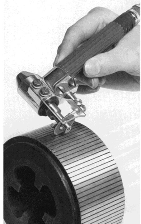
Scie pneumatique pour fraiser l'isolant des collecteurs
