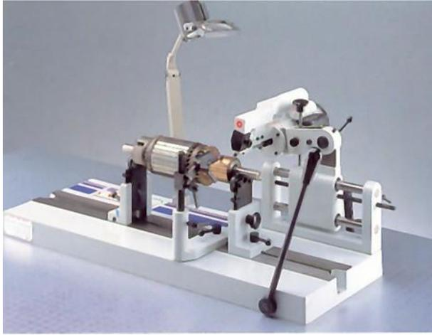
Scies électriques pour fraiser l'isolant des collecteurs
