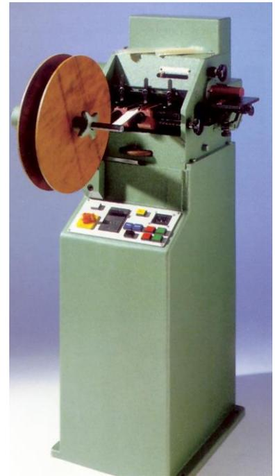
Machine pour plier et pour border les isolants d'encoche
